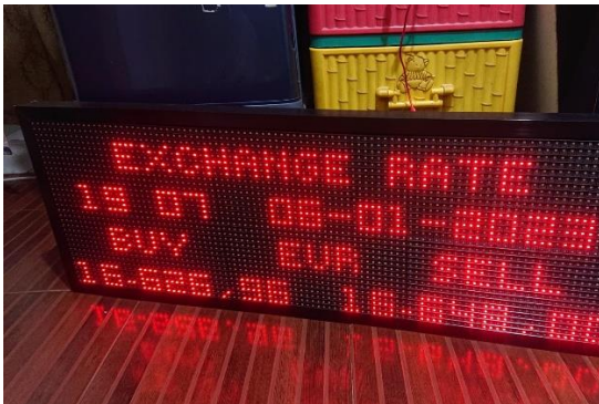
Gambar 4. Hasil Perancangan Perangkat Keras Menampilkan Nilai Mata Uang dan Waktu
