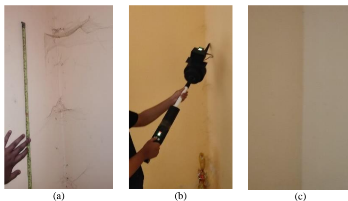
Gambar 13. Hasil pengujian kinerja alat SCONER tanpa tongkat (a) kondisi sebelum dibersihkan, (b) proses pembersihan tanpa tongkat, (c) kondisi setelah dibersihkan
