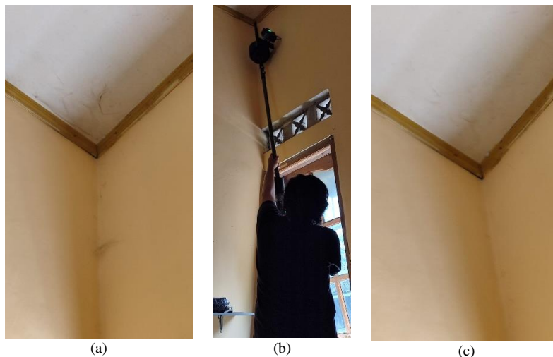
Gambar 12. Hasil pengujian kinerja alat SCONER (a) kondisi sebelum dibersihkan, (b) proses pembersihan dengan kepanjangan alat 160 cm, (c) kondisi setelah dibersihkan
